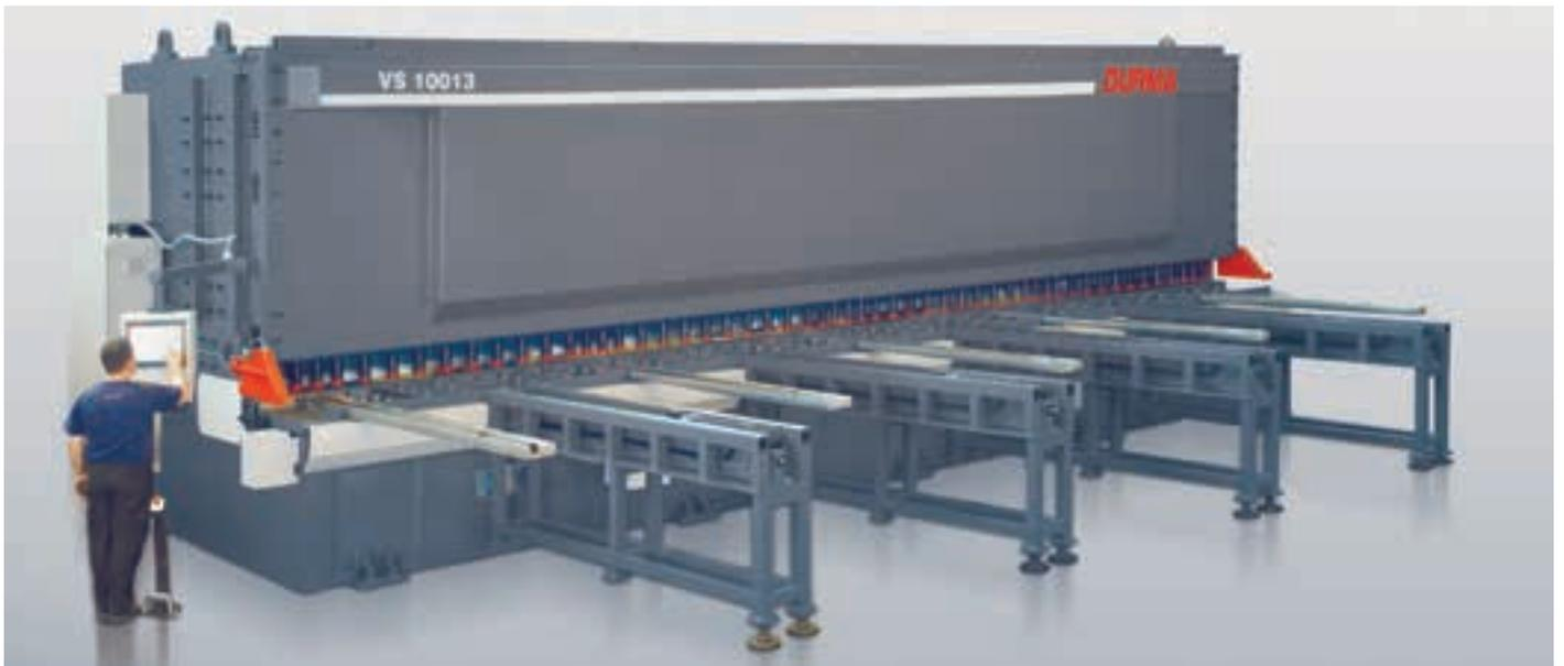
Die Kulissenschnittschere VS von Durma überzeugt durch Ihre einfache Handhabung. Der Schnittspalt und die Schnittwinkel sind einfach durch die CNC-Steuerung einstellbar. Sie genügt aufgrund ihrer Funktionen höchsten Ansprüchen bei differenzierteren Aufgaben. Der Hinteranschlag kann nach oben geschwenkt werden um ein Arbeiten in unbegrenzter Länge zu ermöglichen.
